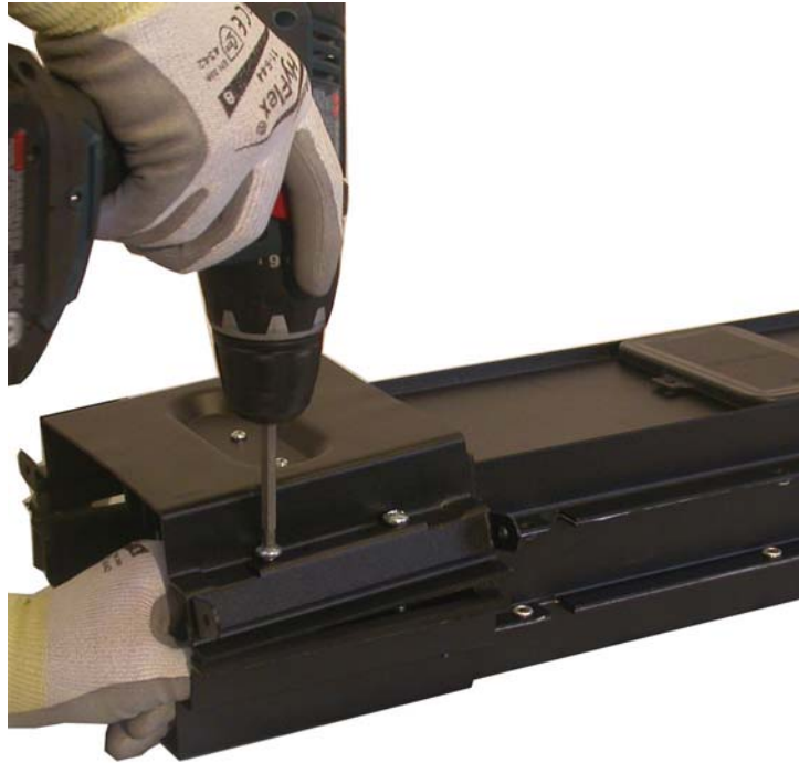
Figura 16: Instalación de los tornillos de brida en los soportes de sujeción
