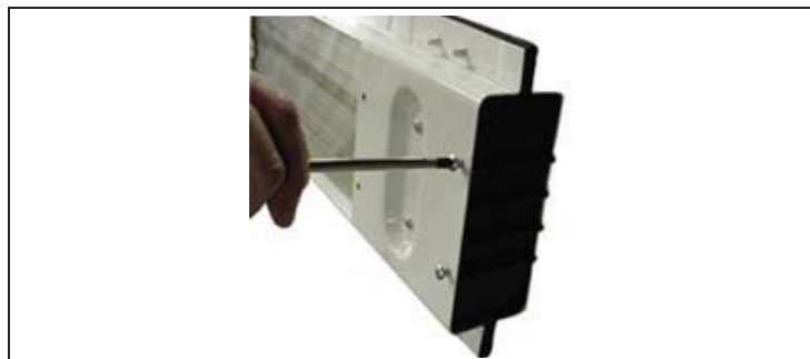
Figure 14 : Serrage des vis autoformeuses d'extrémité Plastite ®
