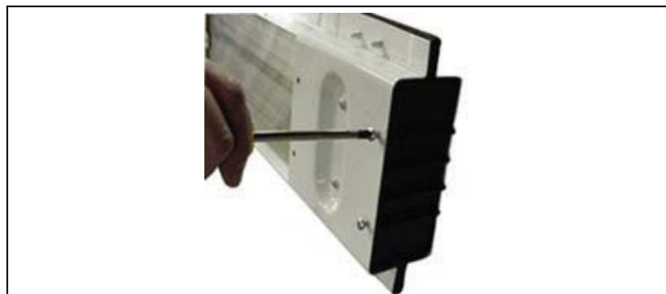
Figura 14: Cómo apretar los tornillos formadores de roscas Plastite®
