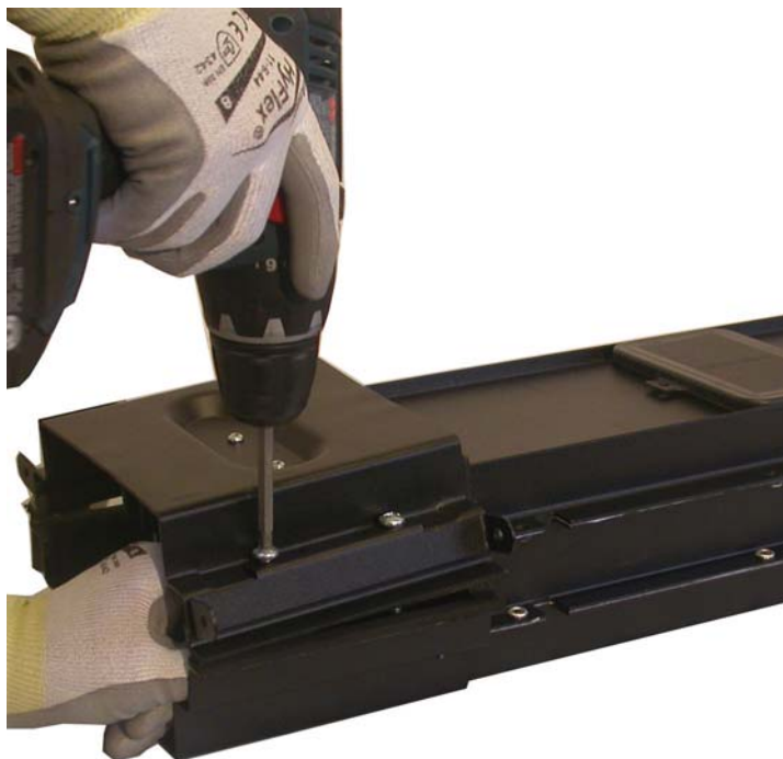
Figure 16 : Installation des vis de bride sur les supports de serrage
